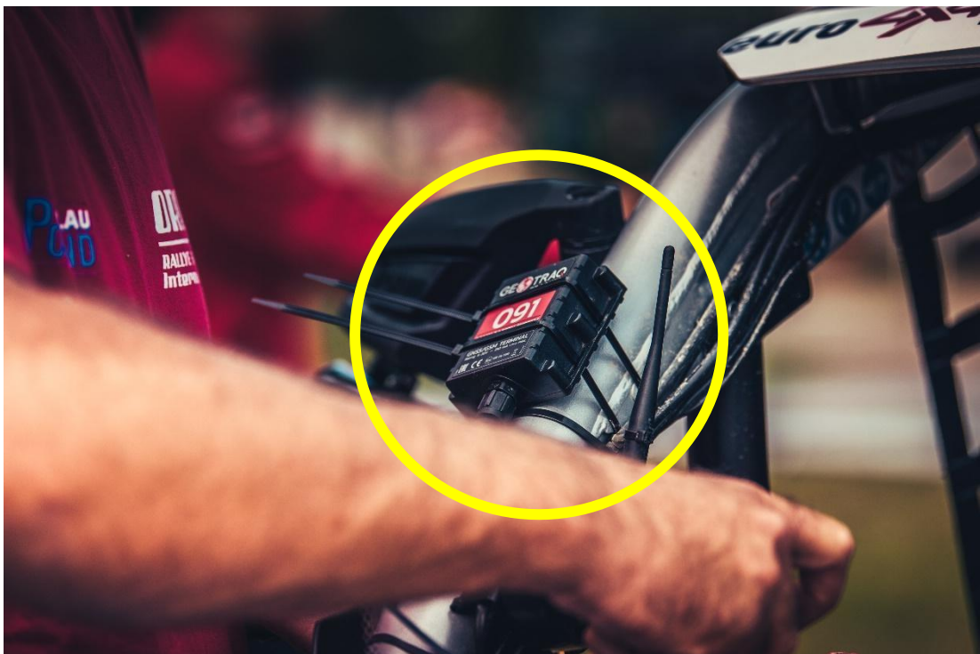
Montaż GPS na klatce bezpieczeństwa "Słupki A" SSV za pomocą opasek kablowych.
