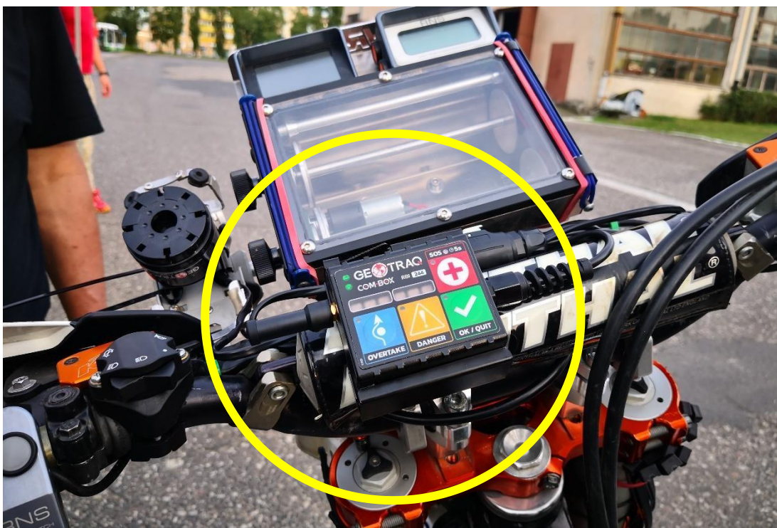
Montaż Com-Box z uchwytem na kierownicy za pomocą opasek kablowych.
