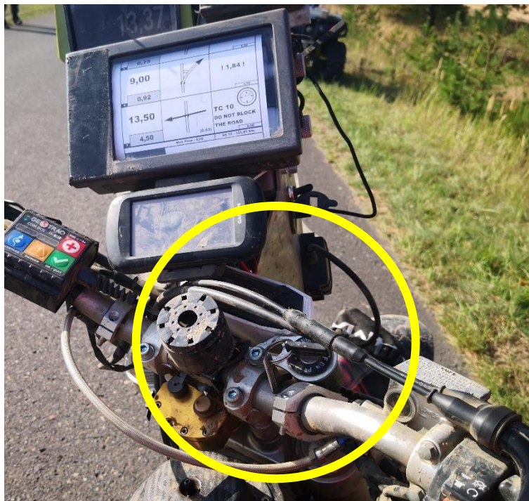
Montaż buzzera ze wspornikiem na kierownicy za pomocą opasek kablowych.
