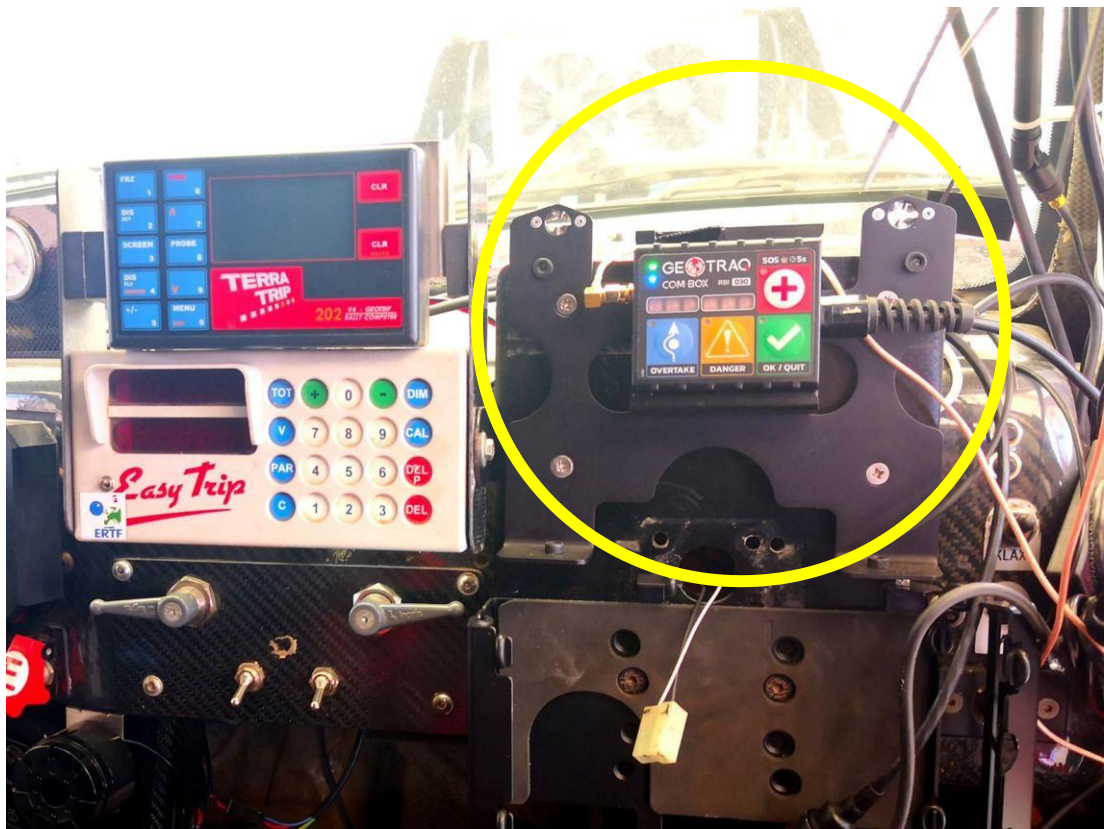
Montaż Com-Box z uchwytem na desce rozdzielczej.
