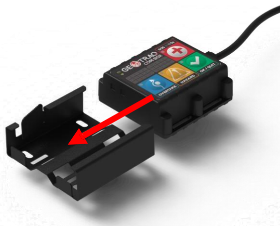
Jednostka Com-Box montowana w uchwycie
