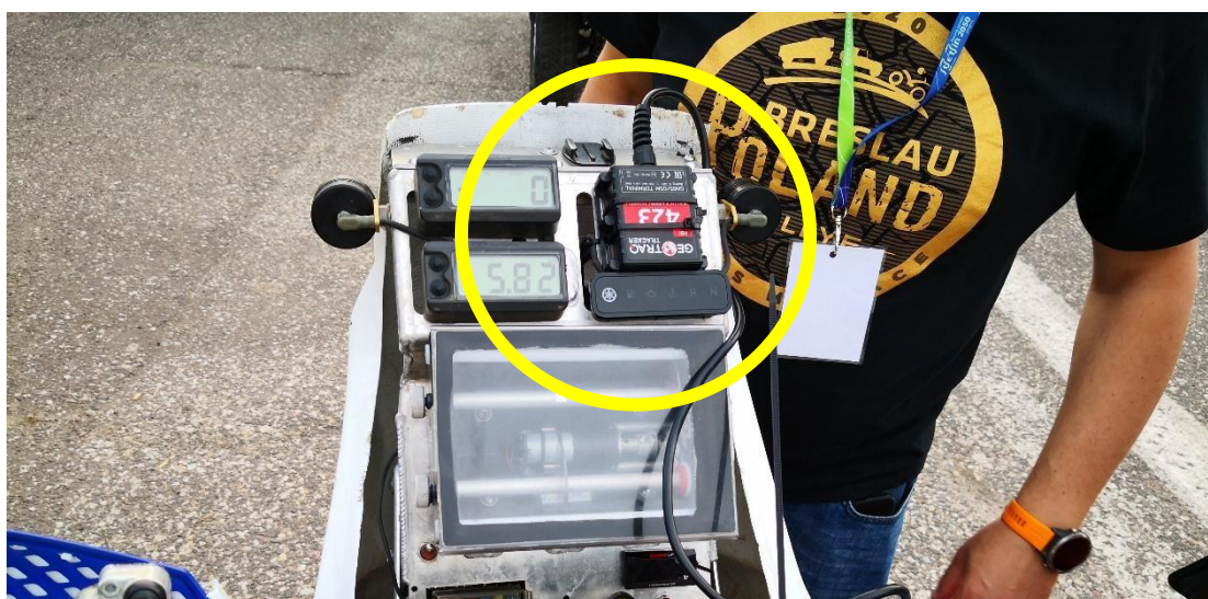
Montaż lokalizatora GPS na wieży nawigacyjnej za pomocą opasek zaciskowych.
