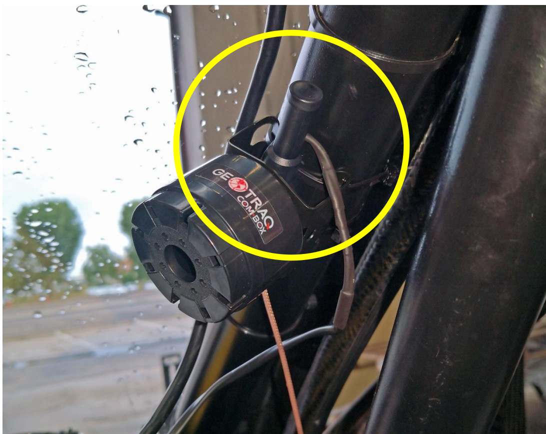
Zainstalowana antena na jednostce Com-Box.
