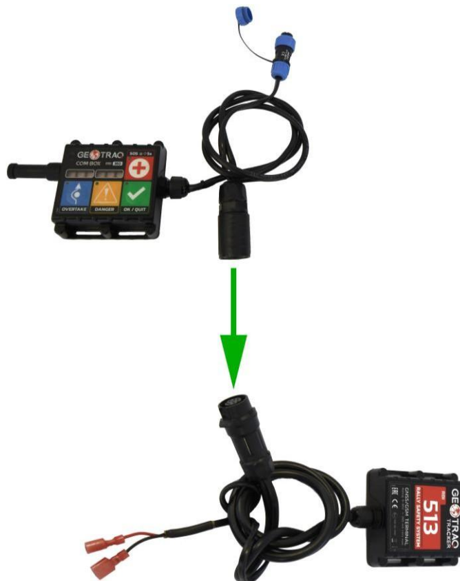
Podłącz COM-BOX do GPS'A.
