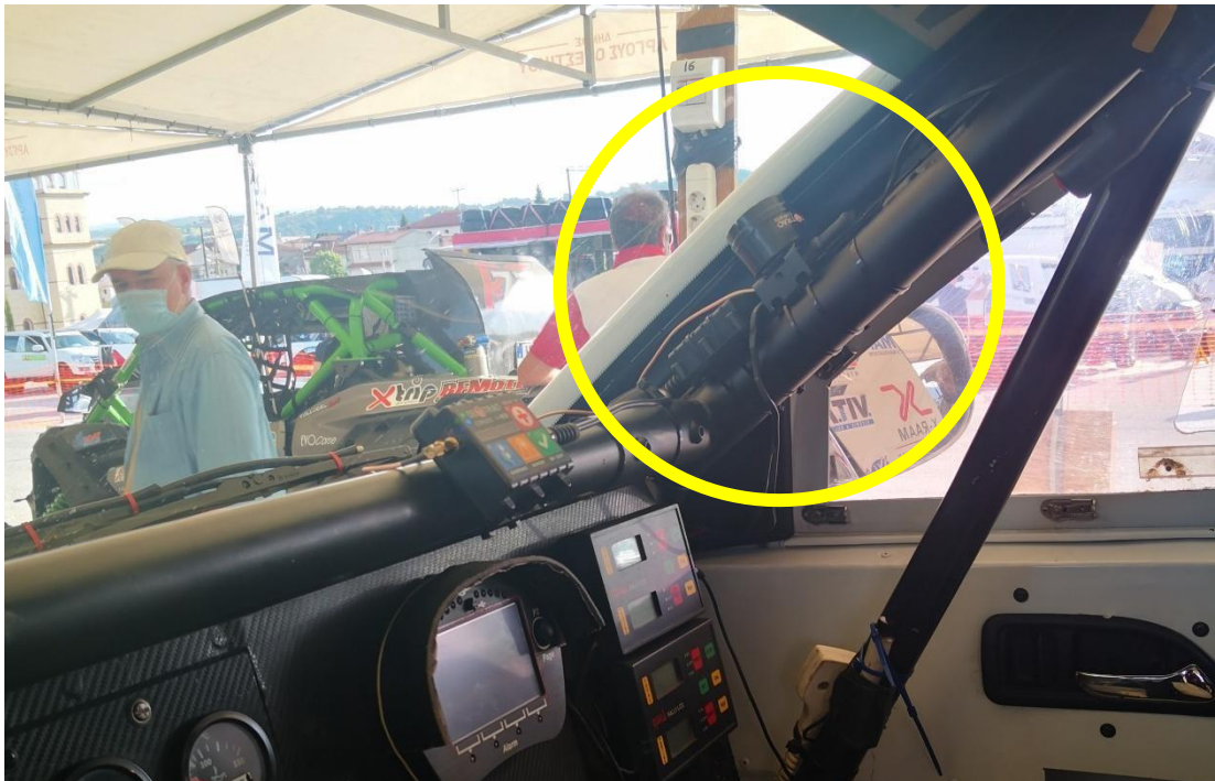
Montaż buzzera ze wspornikiem na klatce bezpieczeństwa za pomocą opasek kablowych.
