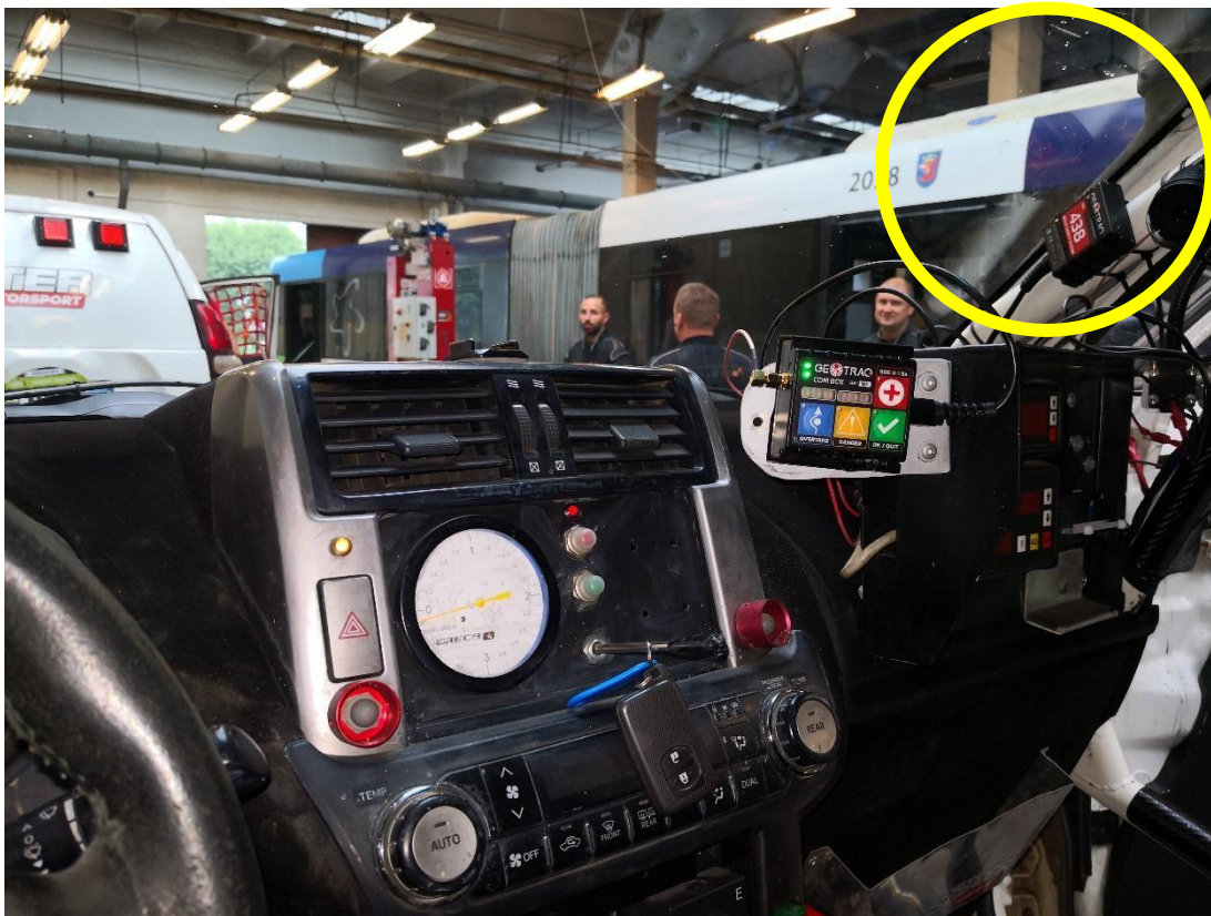
Montaż GPS na klatce bezpieczeństwa "Słupek A" samochodu za pomocą opasek kablowych.
