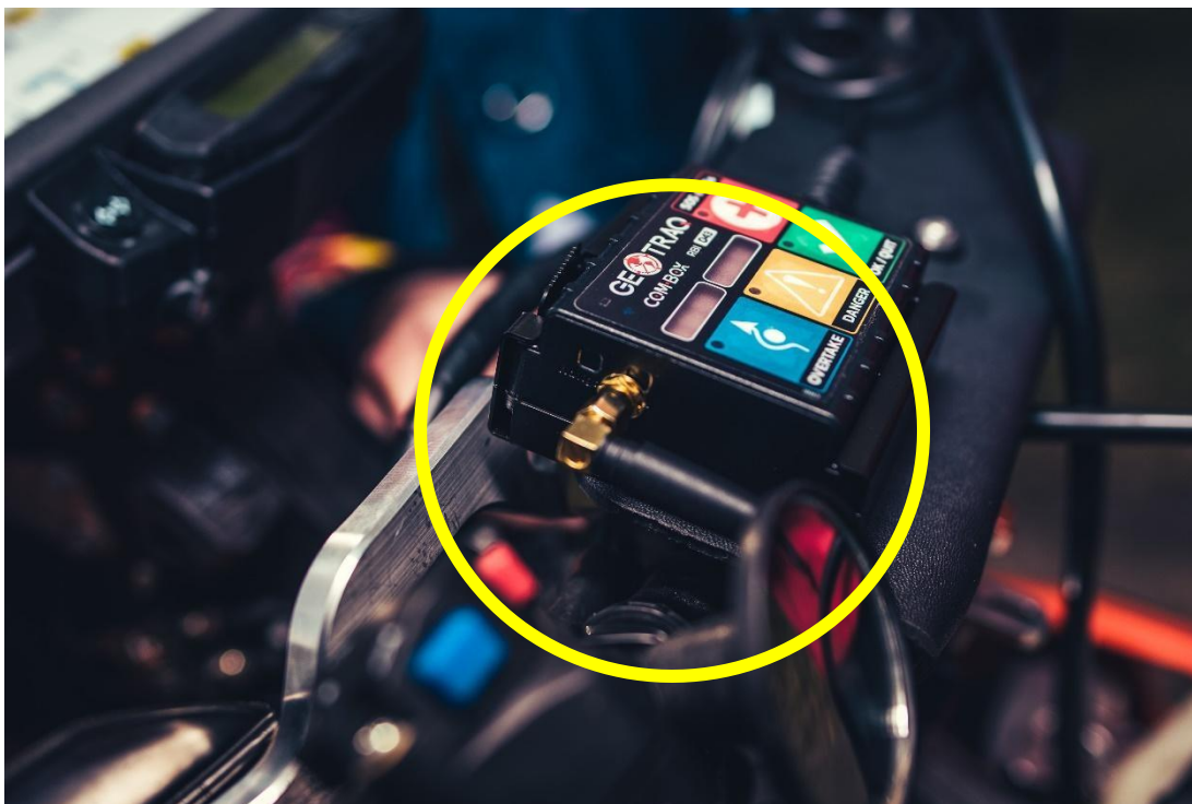
Zainstalowana antena na jednostce Com-Box.
