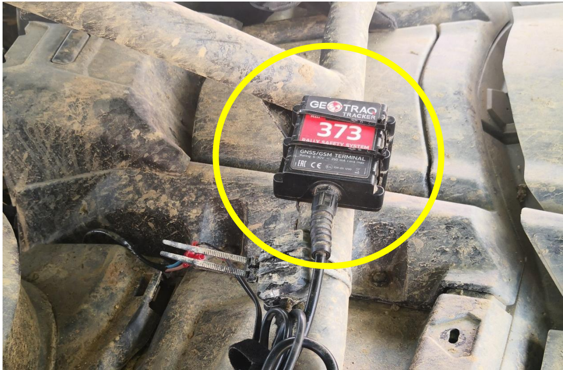
Montaż GPS na relingu ATV za pomocą opasek kablowych.
