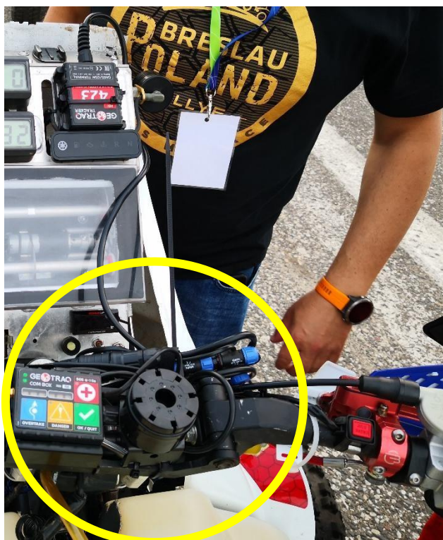
Montaż buzzera ze wspornikiem na kierownicy za pomocą opasek kablowych.
