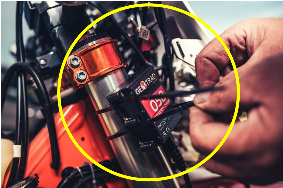
Montaż GPS na widelcu za pomocą opasek zaciskowych.
