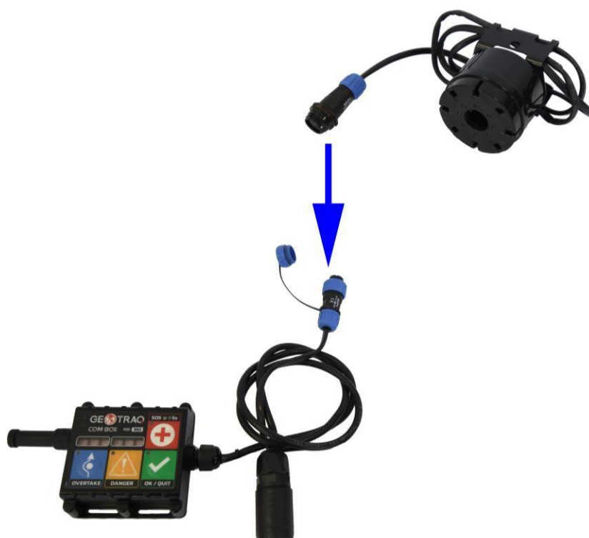
Podłącz BUZZER do COM-BOX.
