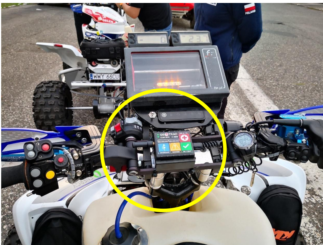
Montaż Com-Box z uchwytem na kierownicy za pomocą opasek kablowych.
